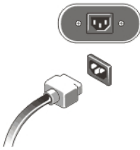
รูปที่ 8. การต่อไฟ
